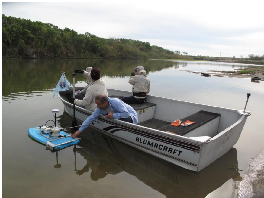
Figura 16. Medición de caudal con equipo RiverSurveyor S5 en el sitio RB10
