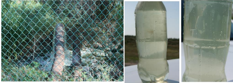
(IZQ) DESCARGA DE ART AL CANAL LOS GURDADOS O PARA SU USO EN LA AGRICULTURA. (DER) CALIDAD DE LAS ART. ES DE LLAMAR LA ATENCIÓN LA BAJA CONCENTRACIÓN DE ALGAS AL NO DETECTARSE VISUALMENTE UNA COLORACIÓN VERDOSA.
