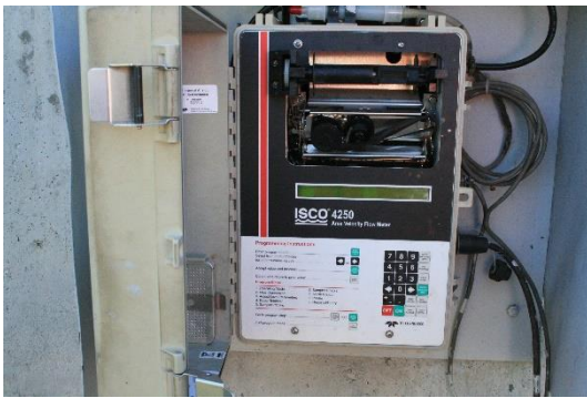
EQUIPO PARA LA MEDICIÓN DEL GASTO DE ART. SE APRECIA UN GASTO DE 679 LPS.
