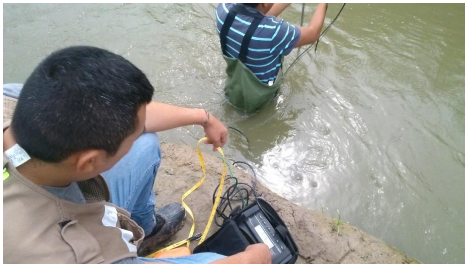
Figura 18. Medición del caudal en un Dren o Afluente con flujómetro.
