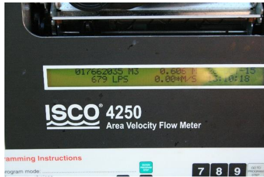
EQUIPO PARA LA MEDICIÓN DEL GASTO DE ART. SE APRECIA UN GASTO DE 679 LPS.
