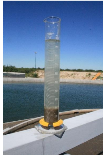
VELOCIDAD DE SEDIMENTACIÓN DE SÓLIDOS DEL LICOR MEZCLADO A LOS 5 MIN Y CÁRCAMO DE RECIRCULACIÓN DE LODOS AL TANQUE ANÓXICO.
