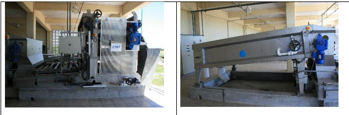
SISTEMA DE DESAGUADO MECÁNICO DE LODOS. SE APRECIA LA MESA VIBRATORIA PARA EL ESPESAMIENTO DE LODOS Y EL FILTRO BANDA.
