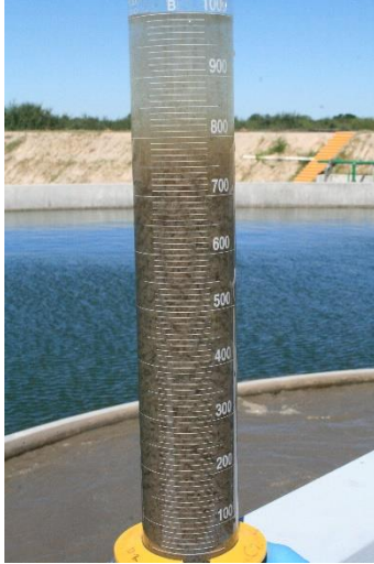
VELOCIDAD DE SEDIMENTACIÓN DE SÓLIDOS DEL LICOR MEZCLADO A LOS 5 MIN Y CÁRCAMO DE RECIRCULACIÓN DE LODOS AL TANQUE ANÓXICO.
