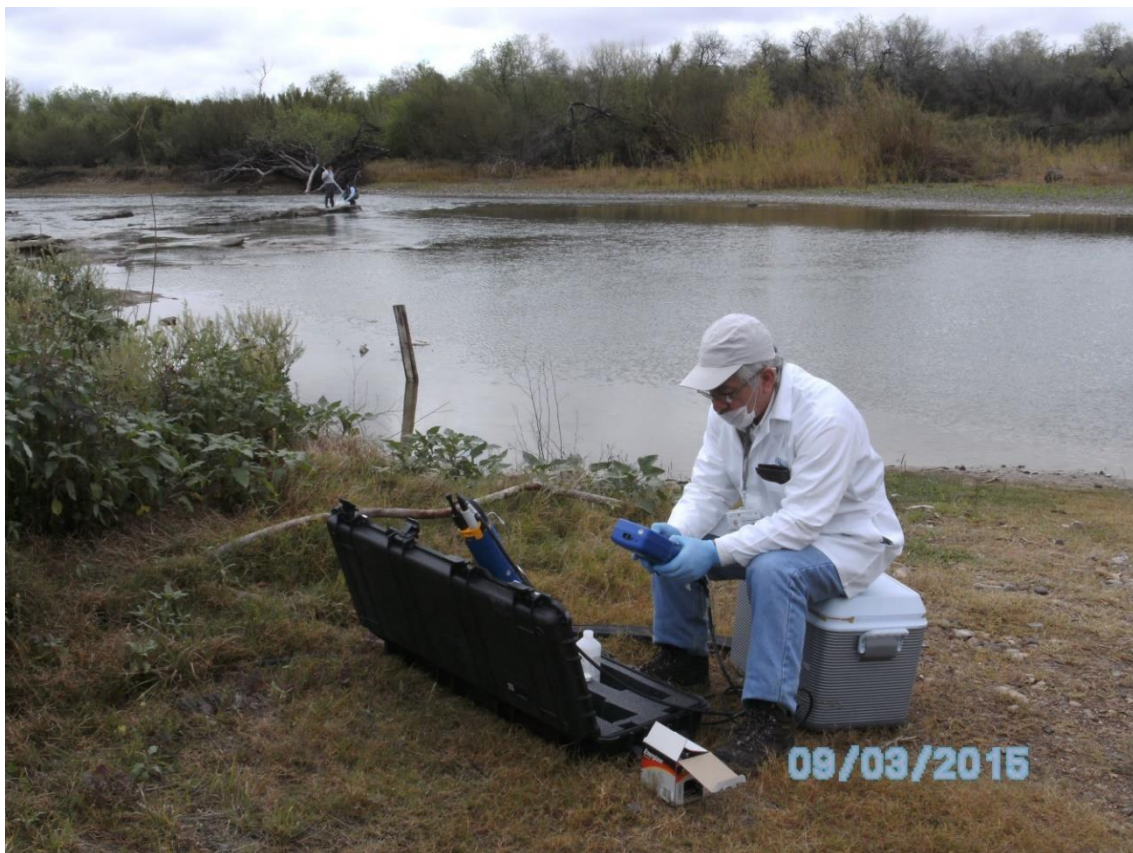
Foto 1. Calibración in situ del equipo multiparamétrico EXXO-YSI y recolecta de muestras de agua al fondo de la foto.
