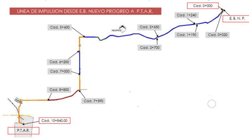
Ilustración 108 Proyecto de rehabilitación de línea de impulsión de Nuevo Progreso, TM.
