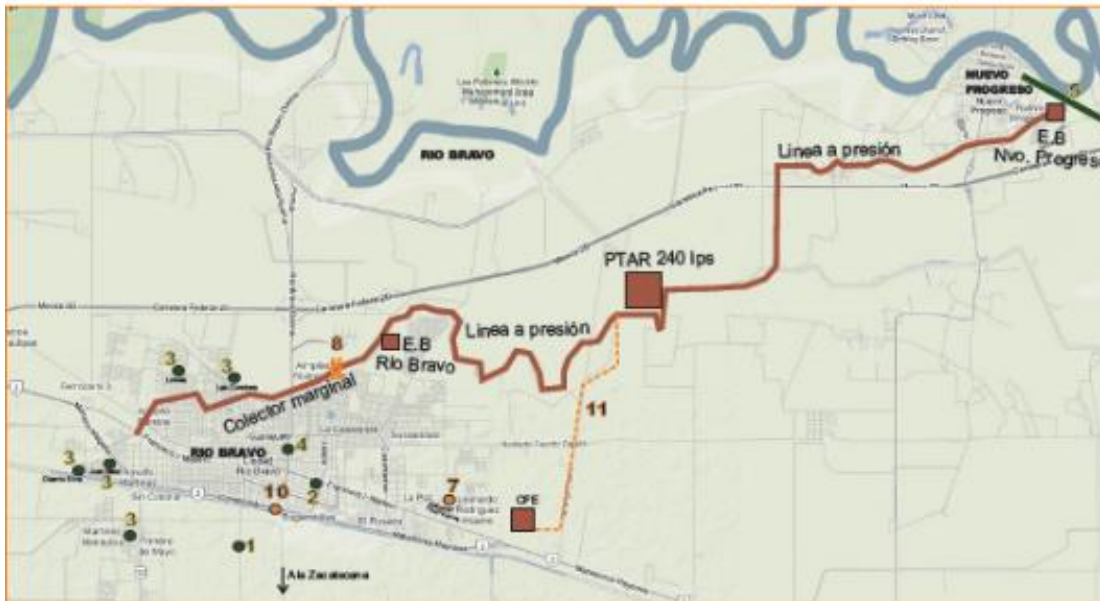
Ilustración 74 Plano de los sistemas de saneamiento de Río Bravo y Nuevo Progreso, TM.
