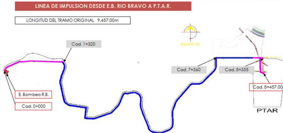
Ilustración 107 Proyecto de rehabilitación de línea de impulsión de PTAR Río Bravo, TM.
