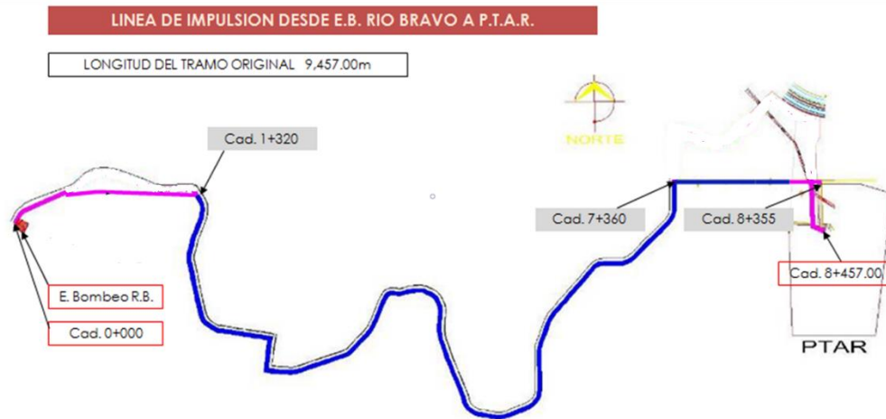
Ilustración1 Trazo de línea de impulsión de Río Bravo a PTAR Río Bravo.
