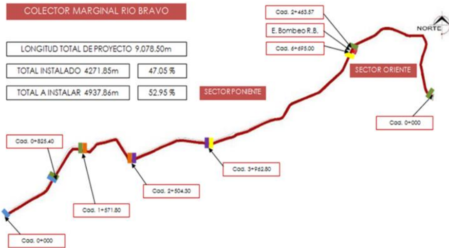
Ilustración 98 Trazo del colector marginal de Río Bravo, TM.
