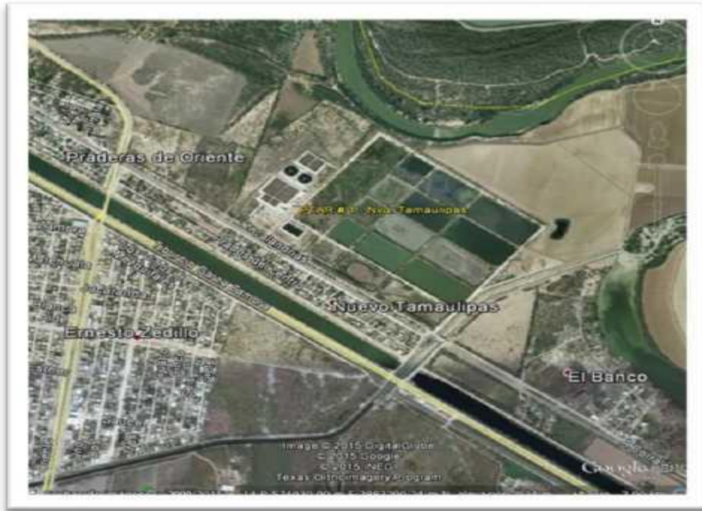
Ilustración 12. Planta de tratamiento N° 1, lagunas de oxidación y lodos activados, Reynosa, TM
