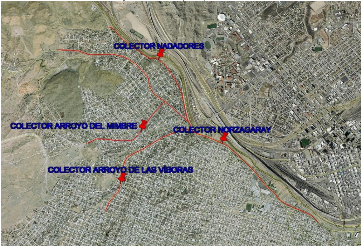
Ilustración 30. Ubicación de algunos colectores que requieren rehabilitación en Ciudad Juárez
