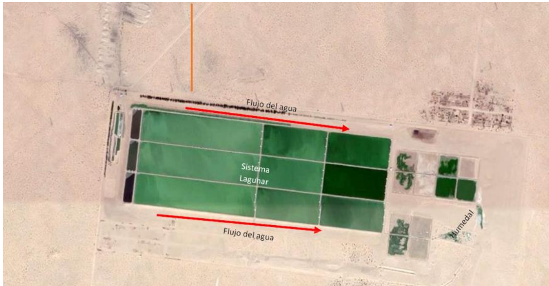
Ilustración 9. Planta general del sistema lagunar de tratamiento de aguas residuales, San Luis Río Colorado
