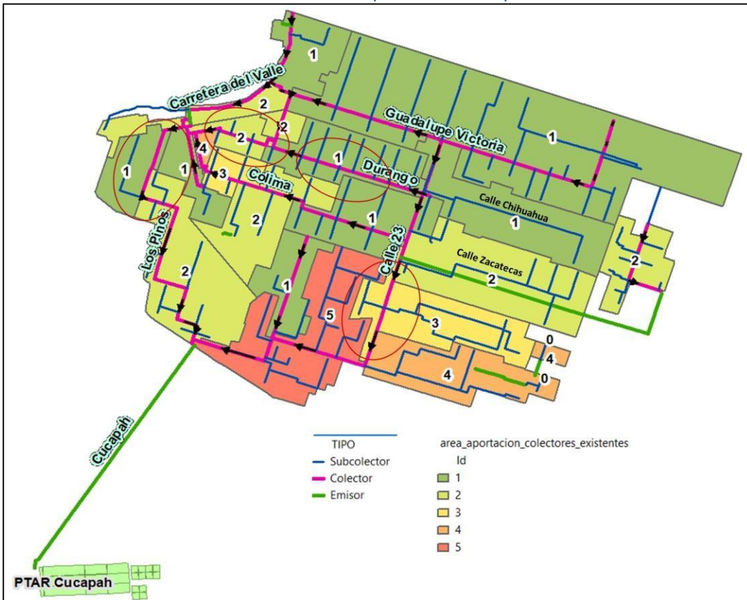
Ilustración 16. Ubicación de tramos con capacidad limitada para el caudal máximo extraordinario
