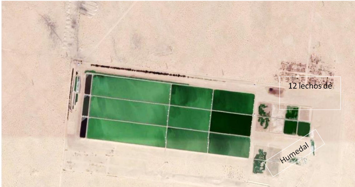
Ilustración 5. Planta general del sistema lagunar de tratamiento de aguas residuales, San Luis Río Colorado
