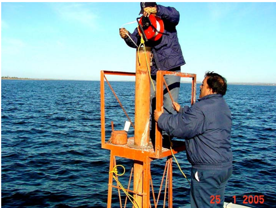
Sondeo de los pozos testigos de nivel freático en el área de la Presa La Amistad.
