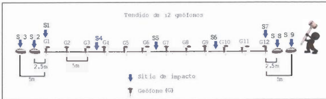
Figura 9. Arreglo utilizado en el tendido 1.
