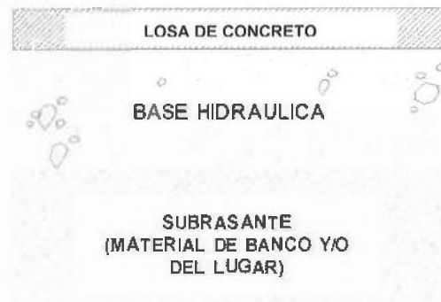
Figura 3 Estructuración de pavimento propuesta para diseño
