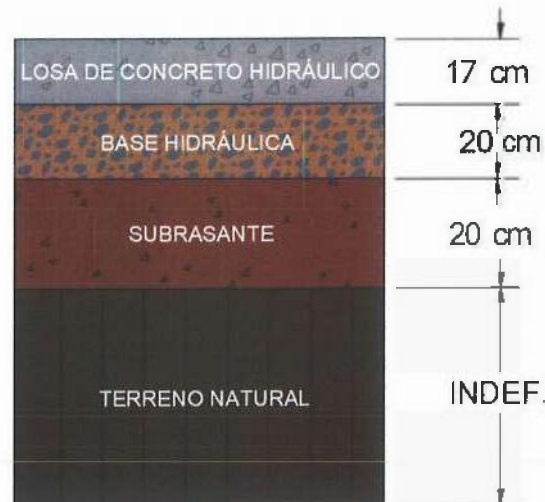
Figura 4 Estructuración de pavimento definitiva
